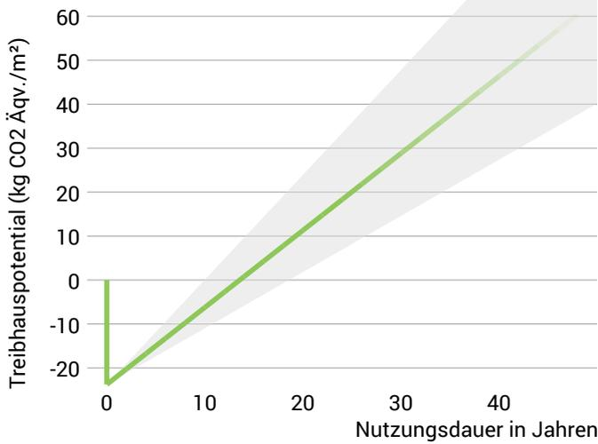
Die **Abbildung links** zeigt im senkrechten Teil der Kurve das Treibhauspotential der Herstellung des Bauteils. Die während der Nutzung des Gebäudes entstehenden Treibhausgasemissionen (durch die Beheizung) sind durch die schräg nach oben verlaufende Kurve dargestellt.
