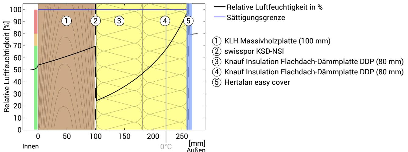
Hinweise: Berechnung mittels Ubakus 2D-FE Verfahren. Konvektion und die Kapillarität der Baustoffe wurden nicht berücksichtigt. Die Trocknungsdauer kann unter ungünstigen Bedingungen (Beschattung, feuchte/kühle Sommer) länger dauern als hier berechnet.
